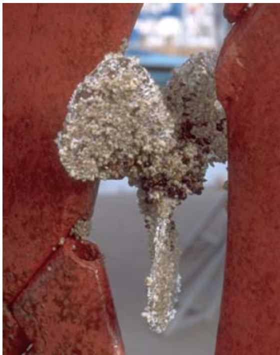
Bilden visar en propeller övertvuxen med havstulpaner. I-Techs produkt medetomidin förhindrar att havstulpanlarven når ytan utan att larven skadas. Istället för fästa till ytan så simmar larven därifrån.
