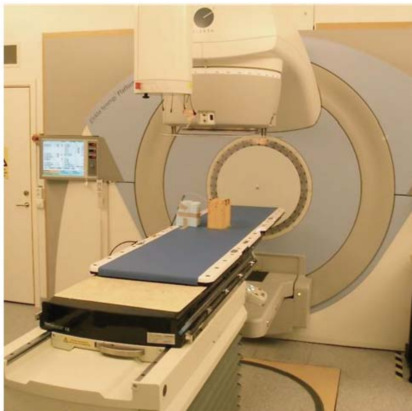
Bild: Micropos RayPilot® system monterad på en Elekta Synergy Platform linjäraccelerator.
